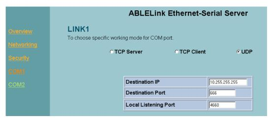
Fig. 29. Com 1 setup -UDP mode
