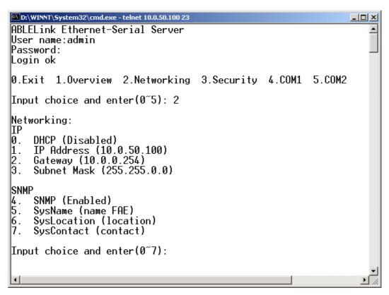
Fig. 12. Network configuring using Telnet
