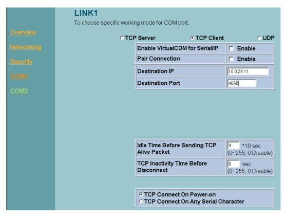
Fig. 27. Com1 setup-TCP client
