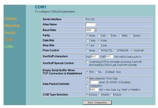
Fig. 26. Com1 setup-TCP server
