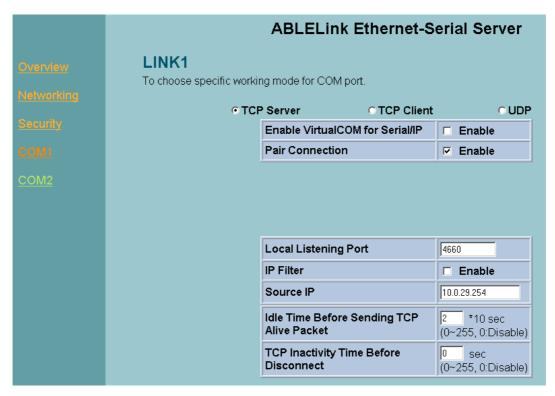
Fig. 28. Com1 setup -pair connection
